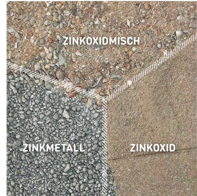
Nach dem Aufschließen des Produktes durch DemiNo® vom dynamischen Windsichter SeparaNo® abgereichert.
