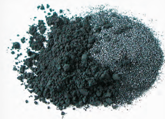
Technische Keramik - Borcarbid ( B_4C ), D_{50} = 10 \mu m
