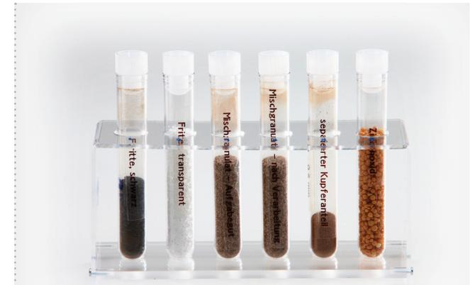
z.B.: Keramik - Glasuren/Fritten (SiO<sub>2</sub>), D<sub>50</sub> = 100µm
