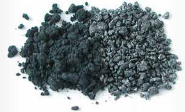
Kohlenstoffe - Graphit Synthetisch ( C ), D 50 = 6 µm
