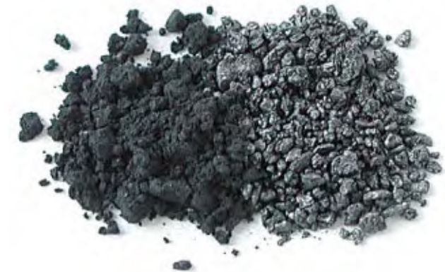
Kohlenstoffe - Graphit Synthetisch (C), D 50 = 6 μm
