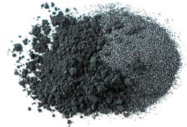
Technische Keramik - Borcarbid (B 4 C), D 50 = 10 μm
